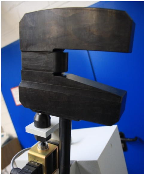
Hammer/Schlag Nase für Holzproben 20x20x300mm Hammer/Hammer edges for wood specimen 20x20x30mm
