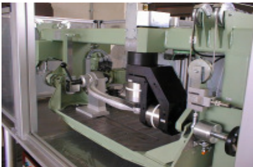
Reibmomentenmessmaschine RMM für Fahrwerksgelenke für den Einsatz im Temperaturbereich von -30 \dots +80^{\circ}\text{C}
